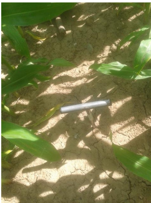
Figuur 11: staalname van een leembodem
