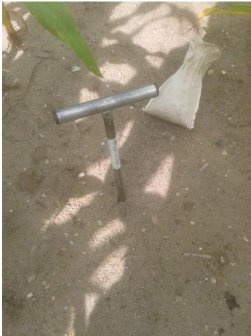
Figuur 9: staalname van een zandbodem
