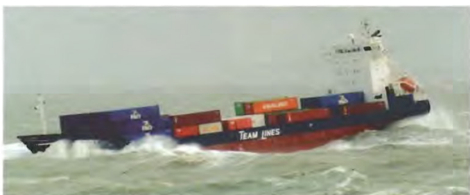
FIGUUR 46 (Van Dokkum, 2003) Een voorbeeld van Sagging
