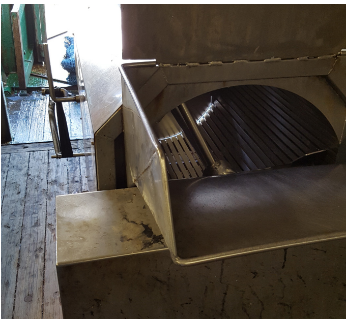
FIGUUR 18 Afbeelding van de sorteertrommel aan boord van de Marie-Louise Z.47.
