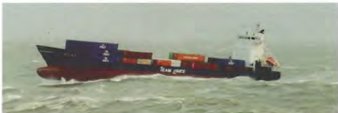
FIGUUR 44 (Van Dokkum, 2003) Een voorbeeld van Hogging
