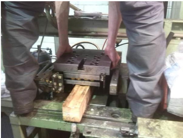
Figuur 6.22: Demontage van het bovenstuk van de pons deel 2
