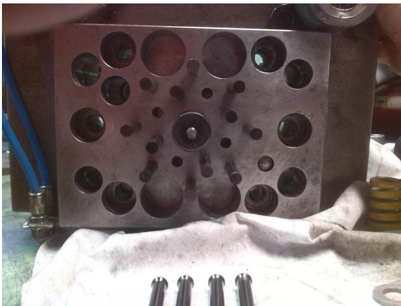
Figuur 6.32: Montage van centrale stempel en twaalf \varnothing 8 stempels
