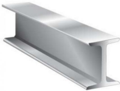
Figuur 14.8: HEB-120 profiel
