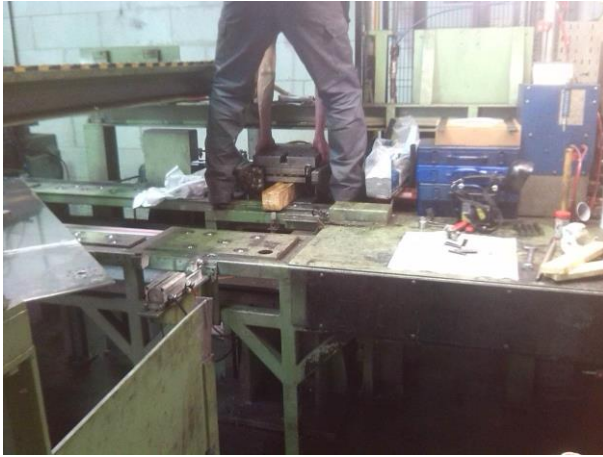
Figuur 6.21: Demontage van het bovenstuk van de pons deel 1
