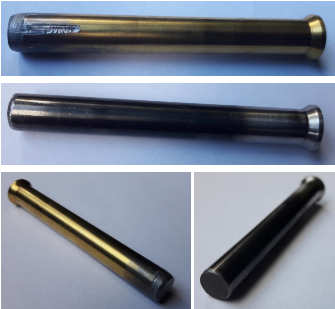
Figuur 6.3: Slijtage bij gecoate en genitreerde stempels
