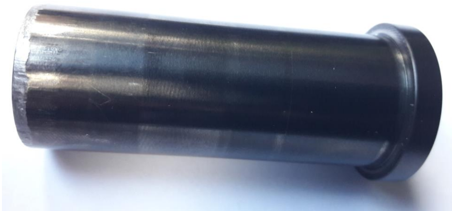
Figuur 6.4: Galling en slijtage bij de centrale ponsstempel
