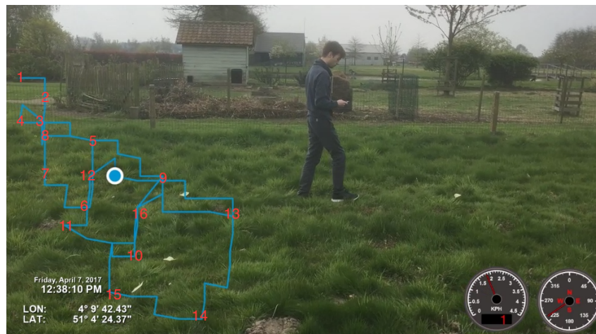
Figuur 37 Waargenomen parcours bij de nauwkeurigheidstest van de Canmore GT 730-FL GPS-logger
