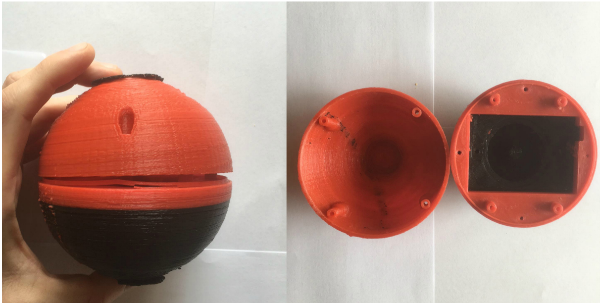
Figuur 39 95 mm boei van Nick Raymond 3D-print Bron: Eigen werk
