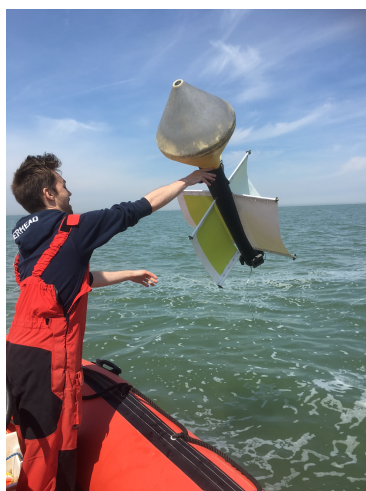
Figuur 62 Het plaatsen van de drifterboei Bron: Eigen werk
