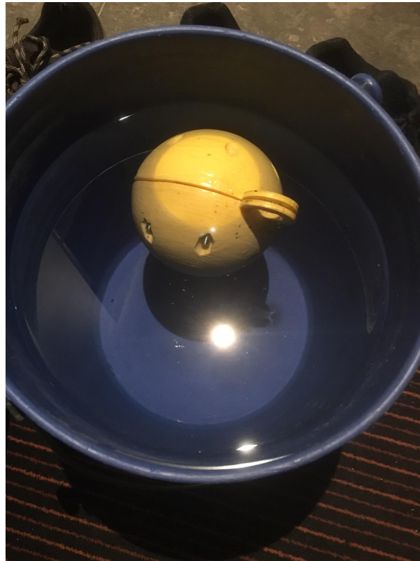
Figuur 50 Drijftest prototype 3 Bron: Eigen werk
