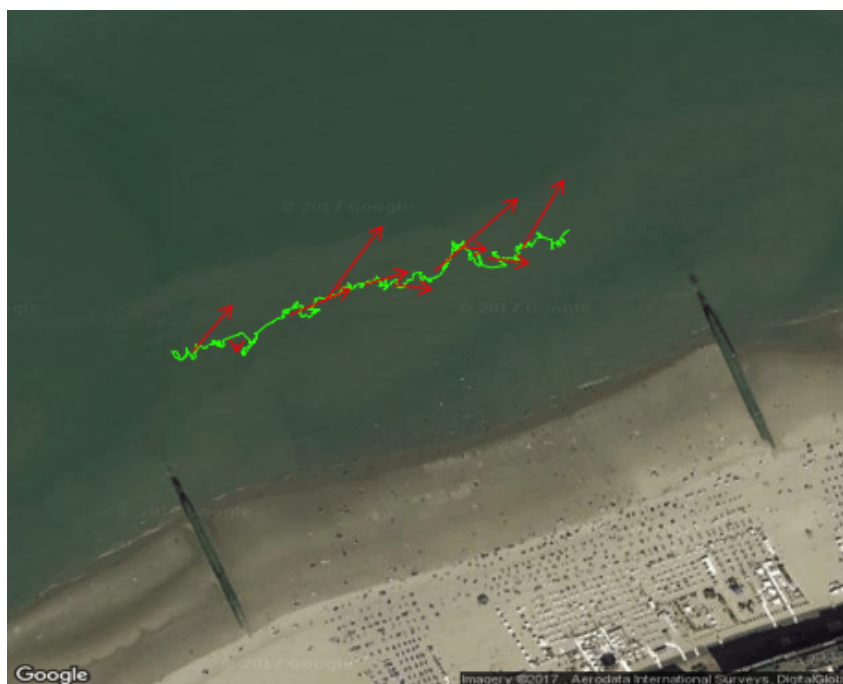
Figuur 68 Traject drifterboei tussen 08:11:24 en 08:26:27 Bron: Eigen werk
