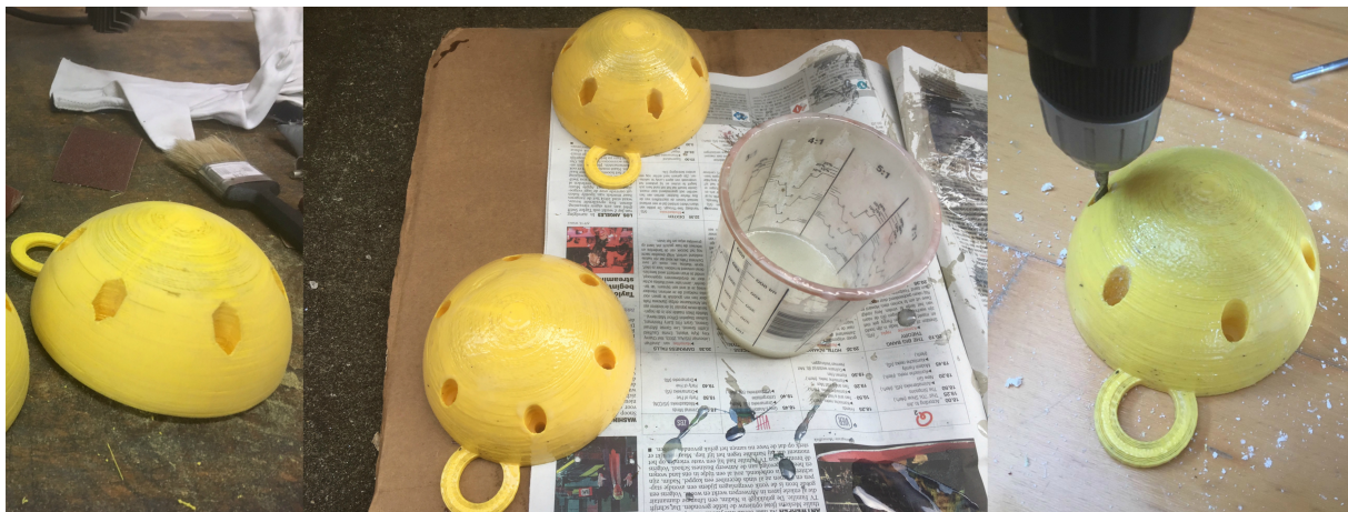
Figuur 48 Toevoeging epoxycoating prototype 3 Bron: Eigen werk
