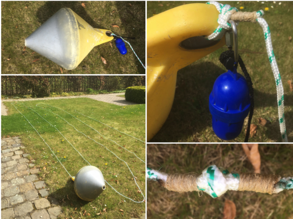
Figuur 52 Ankerboei met waterdichte capsule en touw Bron: Eigen werk
