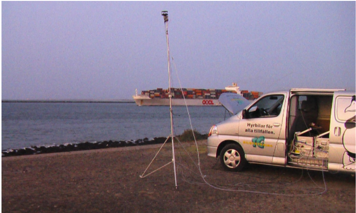
Figure 14 Le dispositif de sniffing déployé à terre par l'Université technologique de Chalmers lors de la campagne de mesure menée en 2009 à Hoek van Holland.
