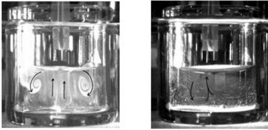
Figuur A.5: Foto's van de gevisualiseerde stroming in water met een helium gasstroom van 1,4 slm, overgenomen uit Hefny et al 131 . Hier zijn de vortices die in ons model opgemerkt worden in de vloeistoffase duidelijk zichtbaar.
