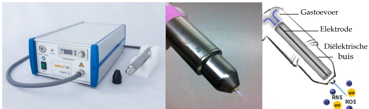
Figuur 8: Afbeelding van de kINPen® IND. Links: foto van de gastoevoereenheid en penvormige houder (voedingsbron niet weergegeven). Midden: foto van de penvormige houder, waarbij de plasmapluij zichtbaar is. Rechts: een schematische voorstelling van de plasmajet, waarbij de centrale pinelektrode, het capillair en de behuizing zichtbaar zijn. Afbeelding overgenomen uit Ref 112.
