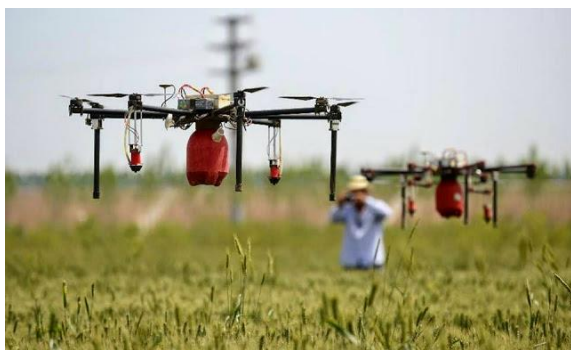
Figuur 2 Drone met insecticide voor gewas besproeiing (Gonzalo Perez, 2016)
