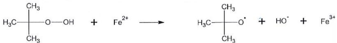
Figuur 2: Redoxreactie tussen tertiair butyl hydroperoxide en \text{Fe}^{2+} . [3]
