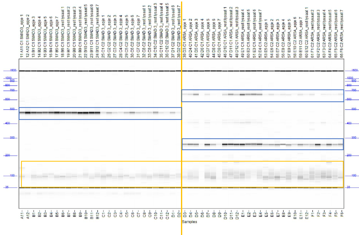
Figuur 29: Resultaten van Fragment Analyzer. Links van de lijn zijn de producten van SMAD3, rechts staan de ARSA-producten. "Epje" staat voor de reacties waarvoor er 7,5 \mu L lysaat werd overgepipetteerd naar een epje met de reactiemix. "Rest lysaat" zijn de reacties waarvoor de mastermix werd toegevoegd aan de rest van het lysaat. De gele kader toont de aspecifieke primerdimeren. De blauwe kader toont links de producten van SMAD3 en rechts de verwachte producten van ARSA.
