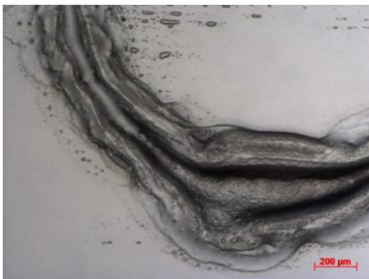
Figuur A.50: Lichtmicroscopie (versterking: 5x) van een ringvormige krater in PMMA-folie door het inkjetetsen bij een druppelafstand van 10 μm.
