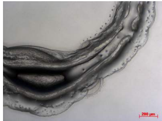
Figuur A.29: Lichtmicroscopie (versterking: 5x) van een ringvormige krater in PMMA-folie door het inkjetetsen van vijf anisol lagen.
