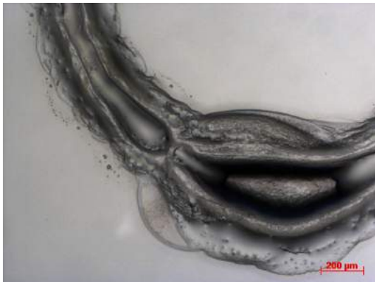
Figuur A.29: Lichtmicroscopie (versterking: 5x) van een ringvormige krater in PMMA-folie door het inkjetetsen van vijf anisol lagen.
