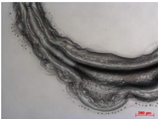
Figuur A.36: Lichtmicroscopie (versterking: 5x) van een ringvormige krater in PMMA-folie door het inkjetetsen met een lijndikte van 200 \mu\text{m} voor het printpatroon.
