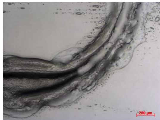
Figuur A.50: Lichtmicroscopie (versterking: 5x) van een ringvormige krater in PMMA-folie door het inkjetetsen bij een druppelafstand van 10 μm.
