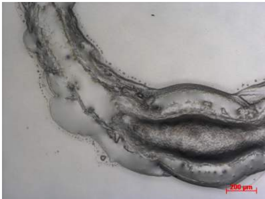
Figuur A.43: Lichtmicroscopie (versterking: 5x) van een ringvormige krater in PMMA-folie door het inkjetetsen bij een basisplaattemperatuur van 40°C.
