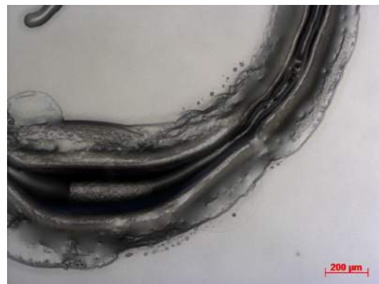
Figuur A.30: Lichtmicroscopie (versterking: 5x) van een ringvormige krater in PMMA-folie door het inkjetetsen van zes anisol lagen.
