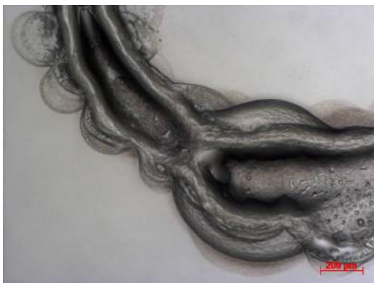
Figuur A.13: Lichtmicroscopie (versterking: 5x) van een ringvormige krater in PMMA-folie door het inkjetetsen met vijf spuitmondjes.
