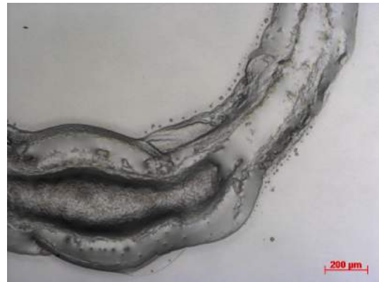
Figuur A.43: Lichtmicroscopie (versterking: 5x) van een ringvormige krater in PMMA-folie door het inkjetetsen bij een basisplaattemperatuur van 40°C.
