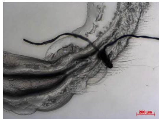
Figuur A.17: Lichtmicroscopie (versterking: 5x) van een ringvormige krater in PMMA-folie door het inkjetetsen bij een printheogte van 250 \mu\text{m} .
