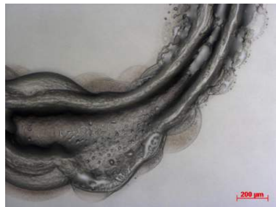
Figuur A.13: Lichtmicroscopie (versterking: 5x) van een ringvormige krater in PMMA-folie door het inkjetetsen met vijf spuitmondjes.
