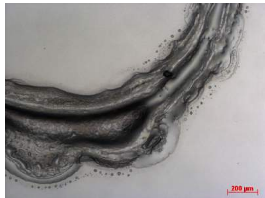
Figuur A.36: Lichtmicroscopie (versterking: 5x) van een ringvormige krater in PMMA-folie door het inkjetetsen met een lijndikte van 200 \mu\text{m} voor het printpatroon.
