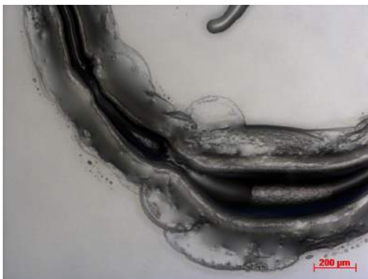
Figuur A.30: Lichtmicroscopie (versterking: 5x) van een ringvormige krater in PMMA-folie door het inkjetetsen van zes anisol lagen.
