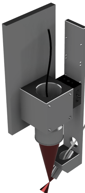
Afbeelding 18: Eindontwerp van tooling voor de pyrometer.
