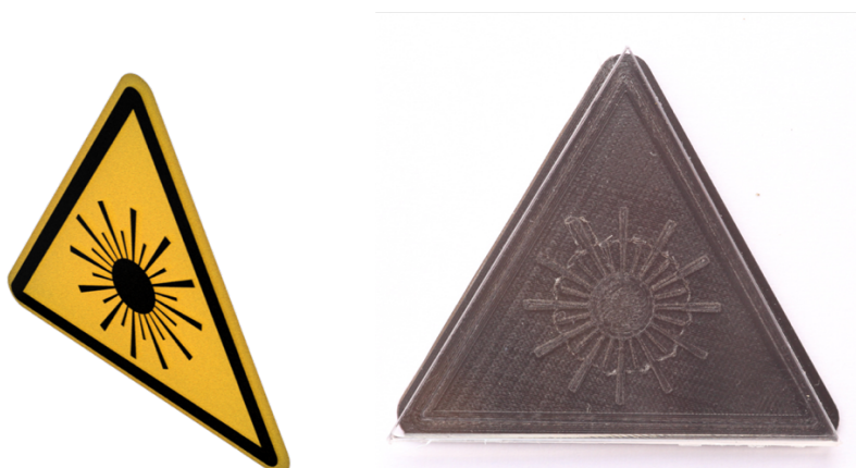
Afbeelding 82: Praktische toepassing van TTLW met een geprint nylon en een transparante PET in het CAD-pakket (links) en het werkelijke resultaat na het lassen (rechts).
