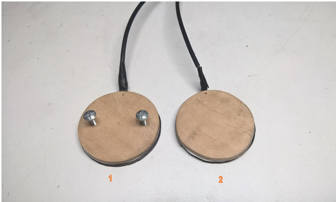
Figuur 15 : Voorbeeld van de BAM-zolen, dynamische voet en statische voet.
