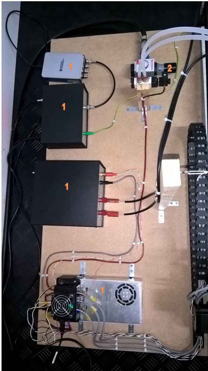
Figuur 19 : Mechanisch en elektronisch gedeelte van de geautomatiseerde loopproef
