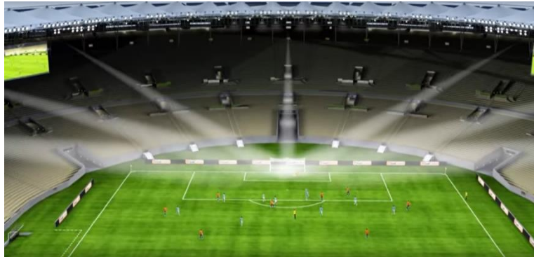
Figuur 1: Illustratie van doellijntechologie via het camerasysteem van GoalControl (GoalControl, 2014).
