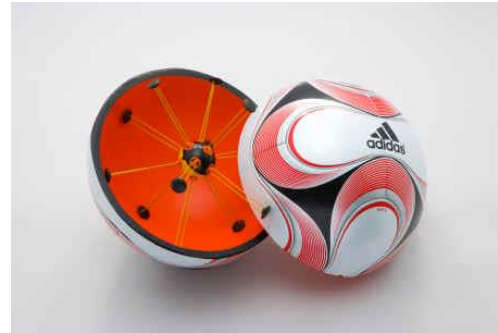
Figuur 2: De Adidas Teamgeist II met ingebrachte sensor. ©Wikipedia
