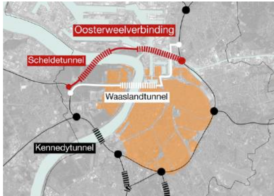
Afb. 3 De Oosterweelverbinding maakt de Antwerpse ring rond. De Scheldetunnel, onderdeel van de verbinding, is naast de Kennedytunnel en de Waasland tunnel de derde Scheldekrusing voor de stad.
