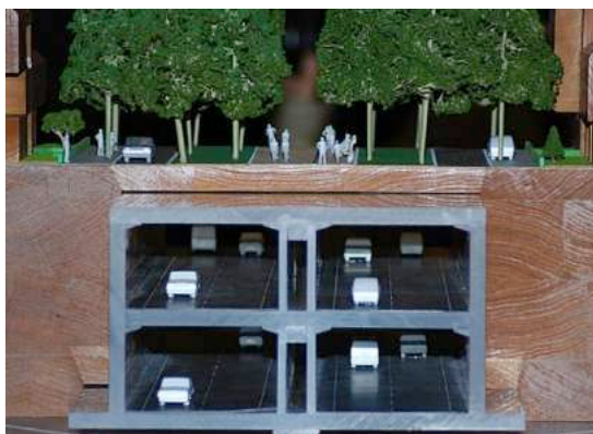
Afb. 56 De Groene Loper in Maastricht scheidt het doorgaande van het lokale verkeer en is zo een 'kleinschalig' prototype voor Ringland.
