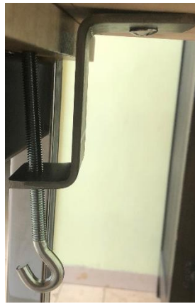
Figuur 27: Bevestiging pennenbak aan schoolbank
