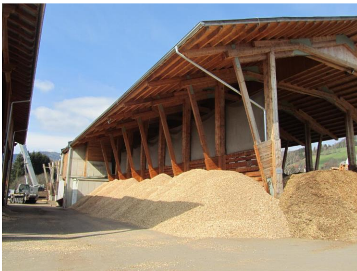
Figuur 6-4 Biomassawerf (Steiermark, Oostenrijk) met passieve droging in open lucht
