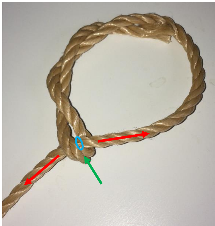
Figuur 3-5 : breuk van het touw, zowel axiaal als op afschuiving belaste toestand.
