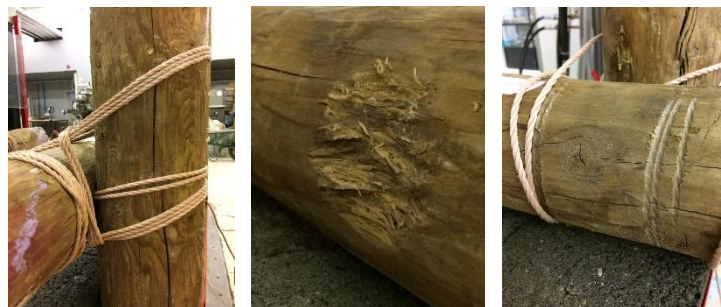
Figuur 5-3 : analyse van de touwen (a) en analyse van de liggers (b+c).
