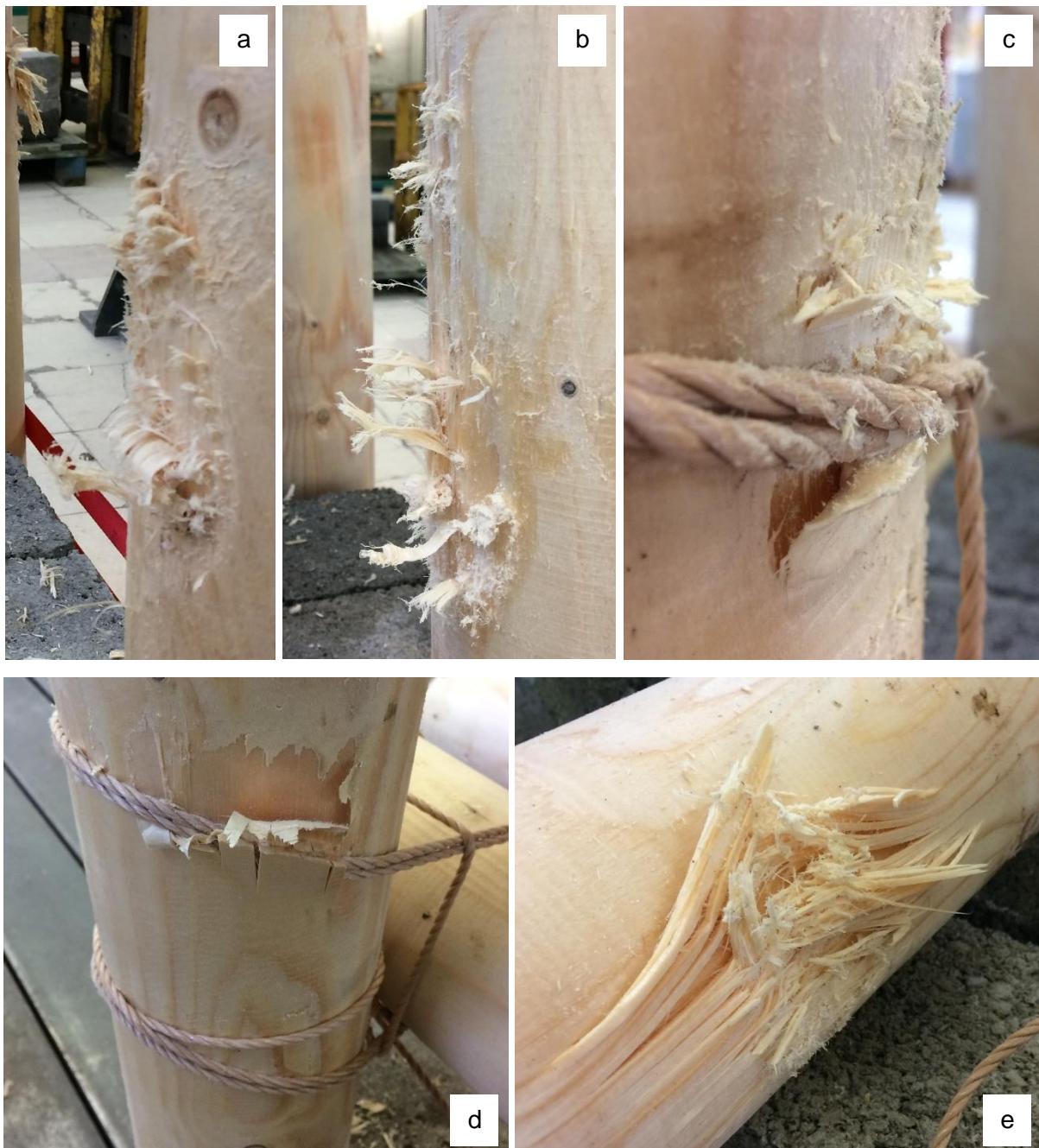
Figuur 6-2 : schade aan houten palen na het beproeven.
