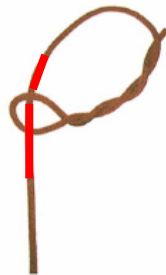
Figuur 6-1 : breuk van het touw in de timmermanssteek (Pollefoort et al., 2009)
