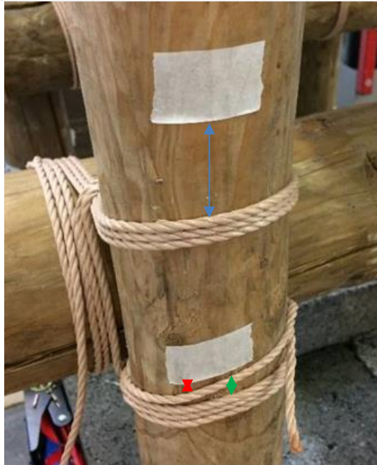
Figuur 5-4 : aanduiding afschuiving van bovenste en onderste touwen op verticale balk.
