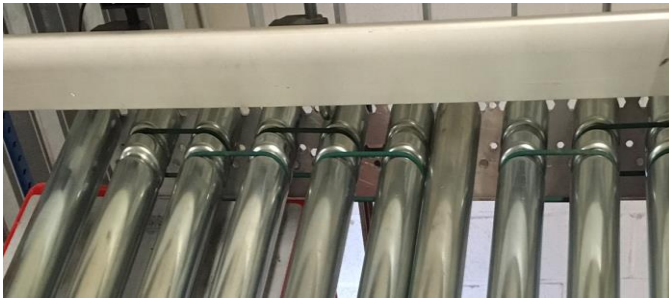
Figuur 42: Riem verbindingen van de rollen (Dalgan, Defoort, Lambrecht, & Mattelaere, 2018)
