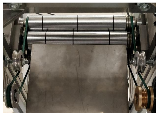
Figuur 23: foto van O-riempjes gemonteerd
