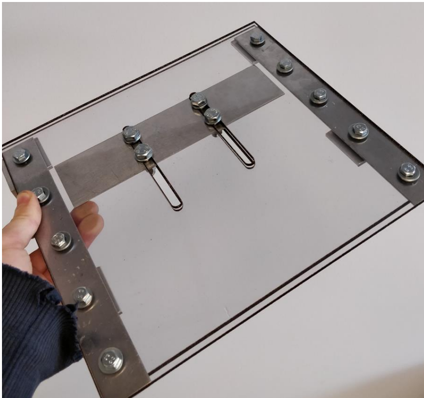
Figuur 34: Het geassembleerde plooiakje met de Laser geprinte onderdelen (Dalgan, Defoort, Lambrecht, & Mattelaere, 2018)
