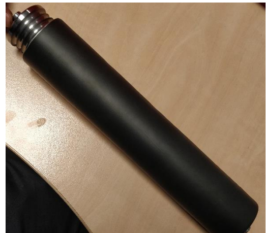
Figuur 31: rol met krimpkous bekleding
