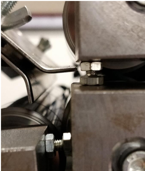
Figuur 37: instel wijsje voor de rollen te regelen
