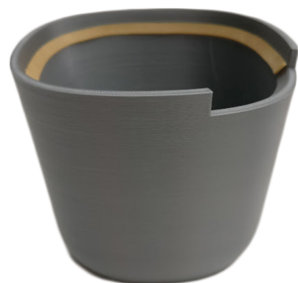
Fig. 118: Lekdicht maken van 2de prototype.
