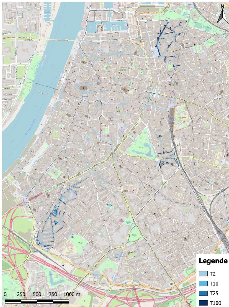
Figuur 5.14: Overzicht van het overstromingsgebied voor de verschillende terugkeerperiodes in het huidige klimaat op basis van de 1D naar 2D-visualisatiemethode
