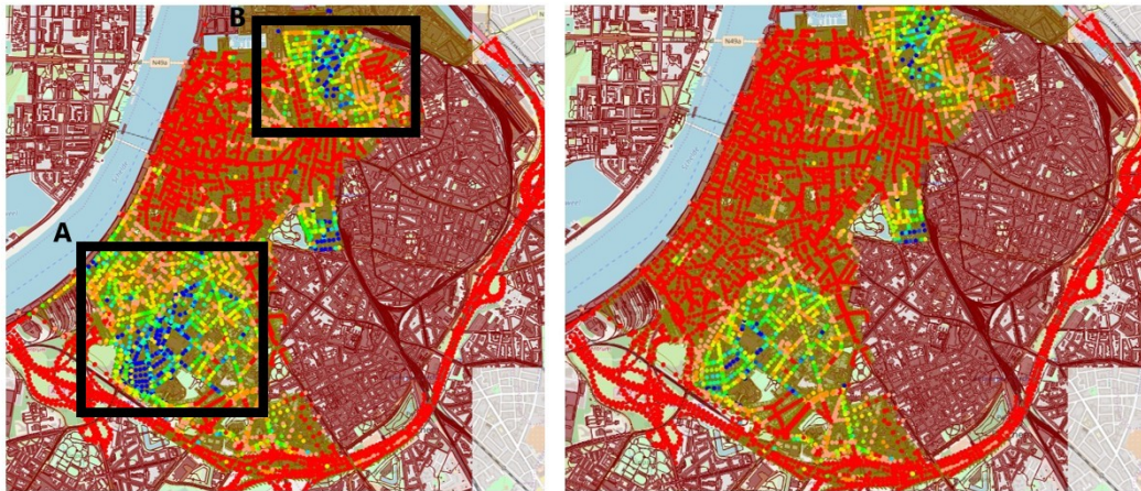
Figuur 3.13: Impact van beschouwen van springtij op het rioleringsnetwerk: Vergelijking voor terugkeerperiode 100 jaar met links de situatie met springtij en rechts de situatie van vrije overstorting zonder springtij
