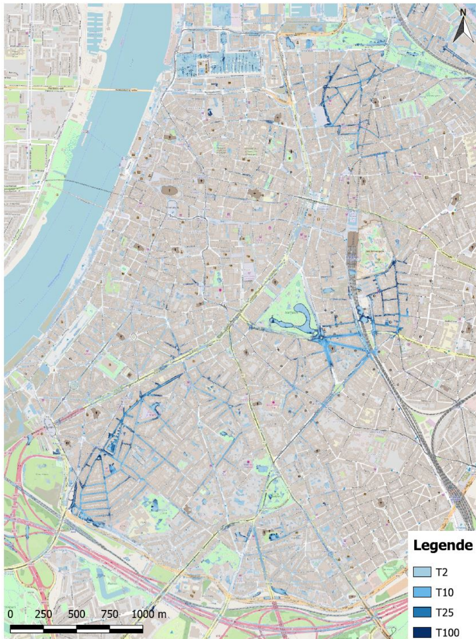
Figuur 5.18: Overzicht van het overstromingsgebied voor de verschillende terugkeperiodes in het Midden klimaatscenario in 2100 op basis van de 2D-visualisatiemethode
