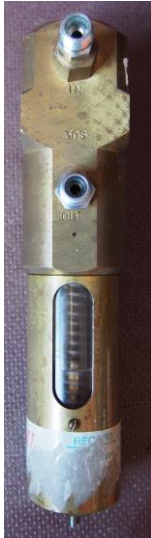
Figuur 23 Mechanisch tijdsvertragsmechanisme Bron: eigen werk
