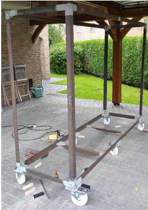
Figuur 13 Stalen frame van het schaalmodel Bron: eigen werk
