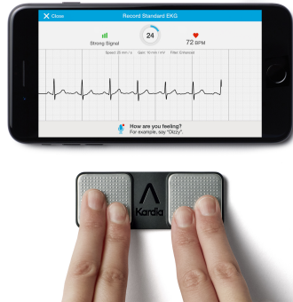
Figuur 1.2: De KardiaMobile™, het mobiele ECG-device ontwikkeld door AliveCor®, en bijhorende app Kardia™. (Afbeelding uit [5])
