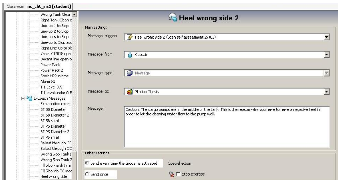
Figuur 103: Bericht 2 voor slagzij aan de verkeerde kant
