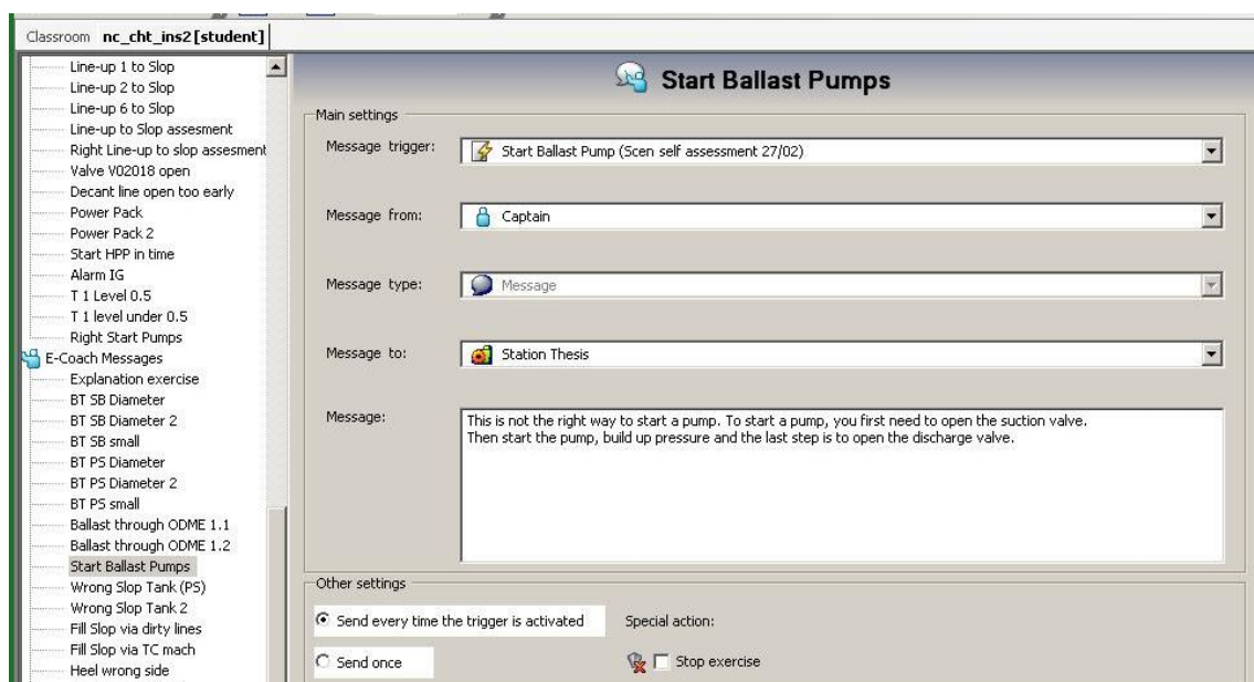
Figuur 92: Bericht voor foutief opstarten ballastpompen
