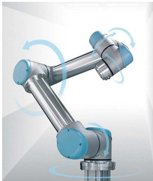
Figuur 5-1 Robotarm met zes vrijheidsgraden [61]
