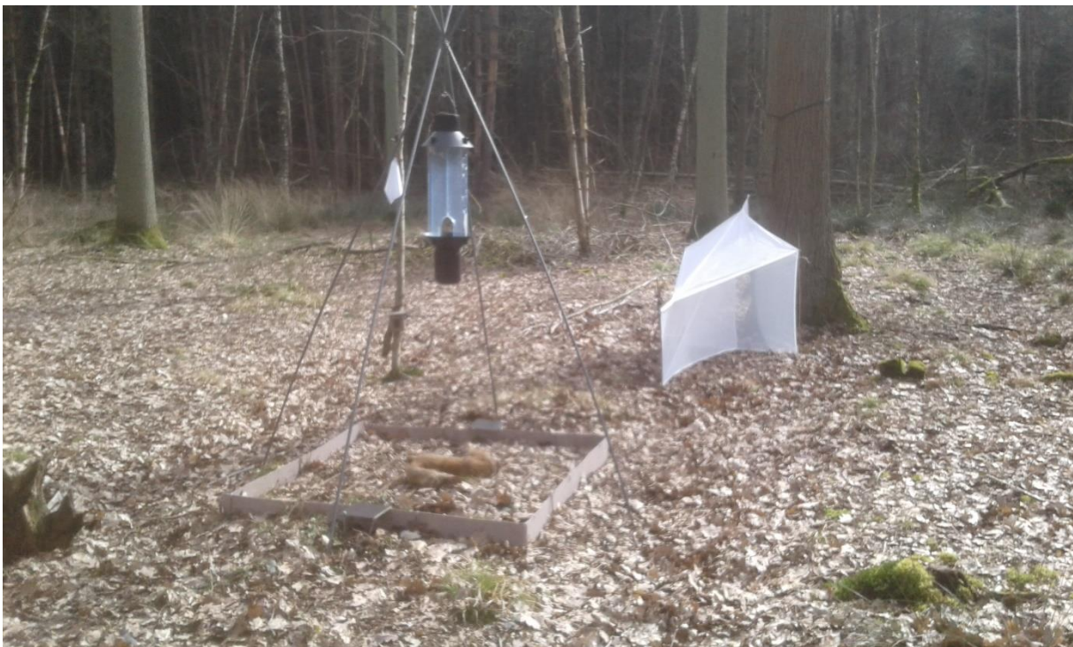
Figuur 4: foto proefopstelling bos met (1) in het midden het reekadaver (2) rechts (wit): malaiseval; (3) boven het kadaver: raamval; (4) rond het kadaver in een rechthoek: rechtopstaande geleiders (grijs) die naar 2 bodemvallen leiden (links en rechts met vierkante afdakjes tegen de regen)
