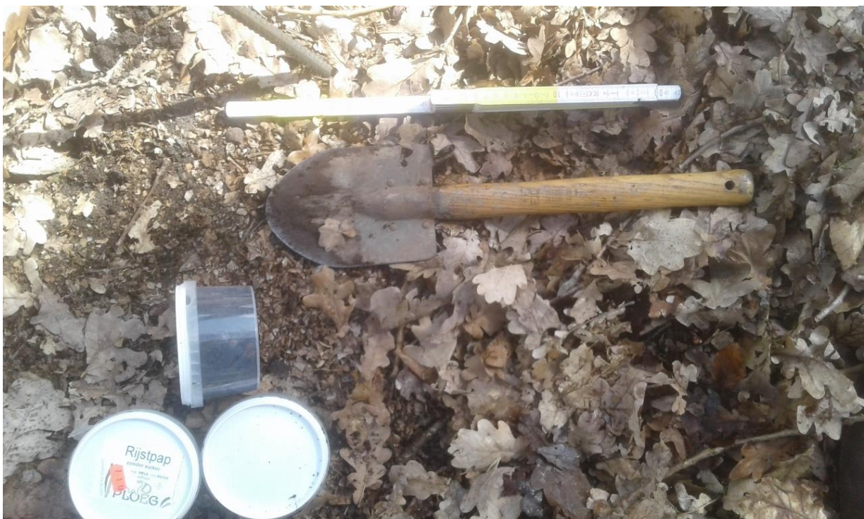
Figuur 16: gereedschap staalname bodem: een vouwmeter, een schop, en drie afsluitbare potjes
