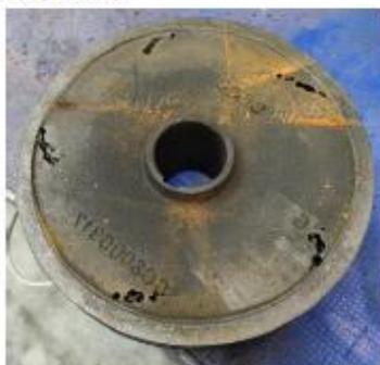
Figuur 4: Pompwaaier met cavitatie na 2 jaar werking
