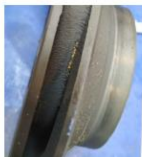
Figuur 7: Uittrede waaier laatste toestand na 6 maanden werking
