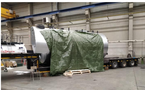
Figuur 39: 7 ton huurketel op trailer
