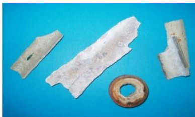
Figuur 22: Kalkbrokken uit ketel met een te hoge waterhardheid
