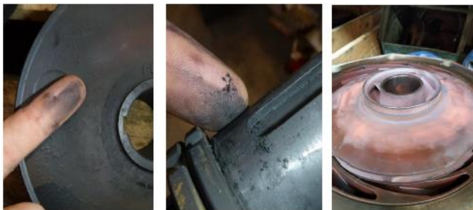
Figuur 8: Afzetting op pompwaaier
