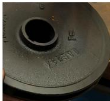
Figuur 5: Pompwaaier bij laatste controle na 6 maanden werking
