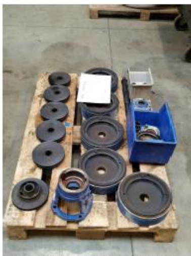
Figuur 1: Pompwaaiers na demontage
