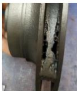
Figuur 6: Cavitatie uittrede waaier na 2 jaar werking
