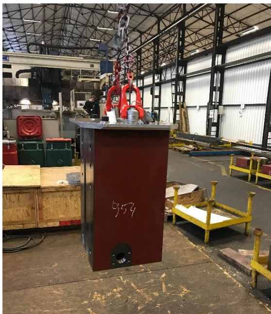
Figuur 83: Verplaatsen van een cilinderblok
