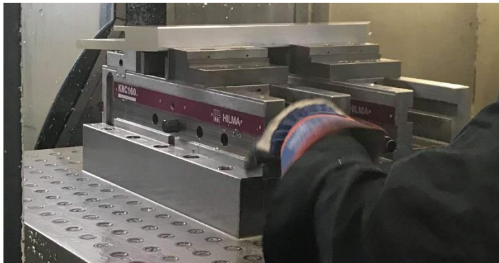
Figuur 67: Opspanning overbrenging aluminiumconstructie
