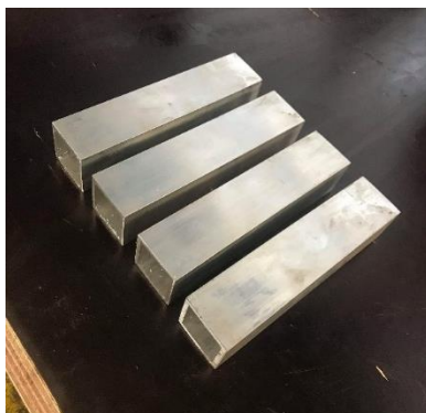
Figuur 64: Gezaagde stukken voor aluminiumconstructie
