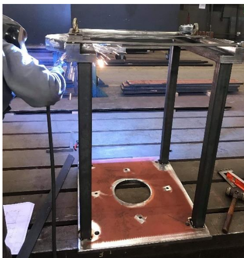
Figuur 60: Volledig lassen van de constructie
