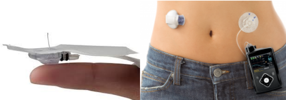
Figuur 4a: Sensor van CGM-systeem. Figuur 4b: Afbeelding van CGM-sensor bevestigd aan het abdomen en verbonden met meettoestel. Noot: beiden overgenomen van Medtronic, (2018), Kalibratie: Waarom moet ik kalibreren? Gevonden op 27/12/2018 op het internet. https://www.medtronic-diabetes.nl/klantenservice/cgm-en-sensoren
