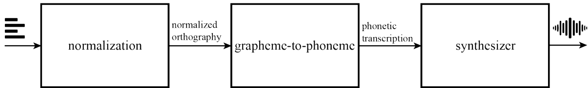
Figuur 1: Blokschema van een TTS-systeem.
