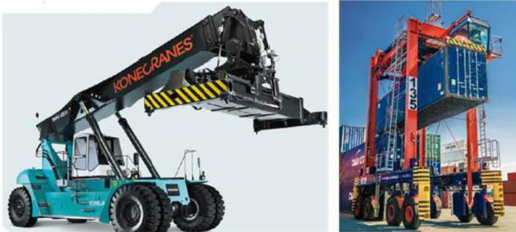
Figuur 3-1 Voorbeelden van een reachstacker [14] (links) en een straddlecarrier [15] (rechts)
