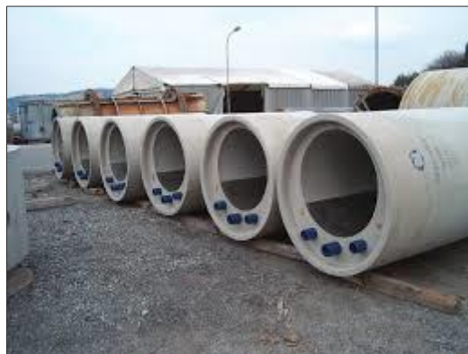
Figuur 2.10: Warmtewisselaar geïntegreerd in riolering
