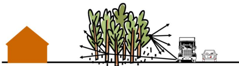
Figuur 4-2: Verstrooiing en reflecties ten gevolge van de verandering van de akoestische impedantie bij vegetatie [8]
