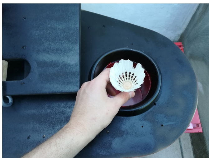
Fig. 5.33 Insteken in vluchtunnel
