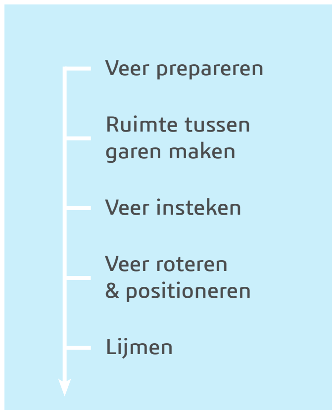
Fig. 2.33 Stappenplan insertie veer
