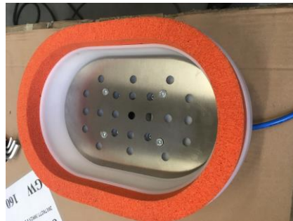
Figuur 6.15 KSG gripper met foam afdichtingsrand
