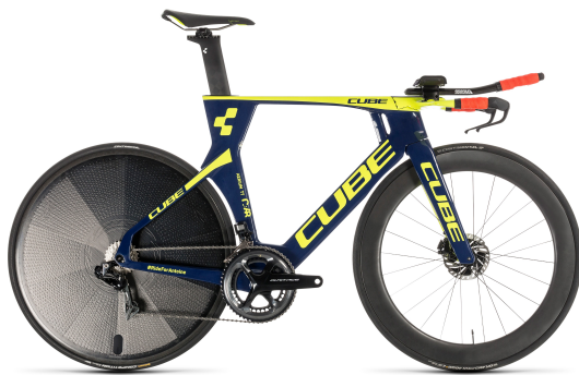
(a) Triatlonfiets met een laag stuur, opzetstuur en vol achterwiel [48]
