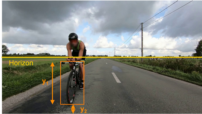
Figuur 50: Principe van de hoogtemethode y_1 en de grondvlakmethode y_2
