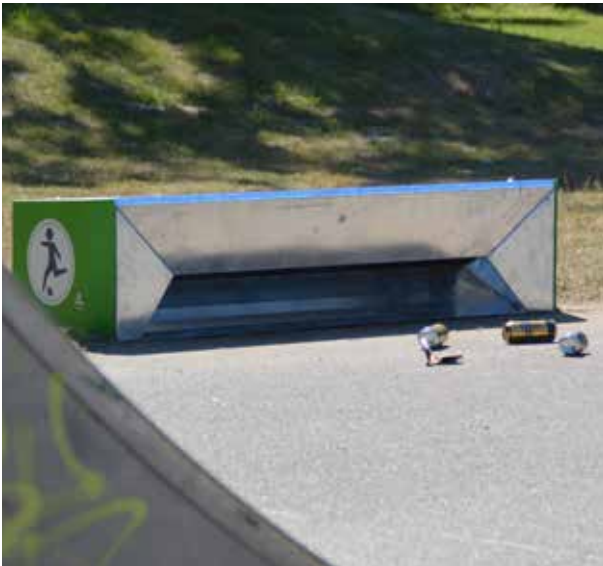
De Hat-trick afvalbank is bedacht om zwerfafval op een leuke manier te verminderen. Door goed te mikken en trappen verdwijnt het vuil via een schans.
