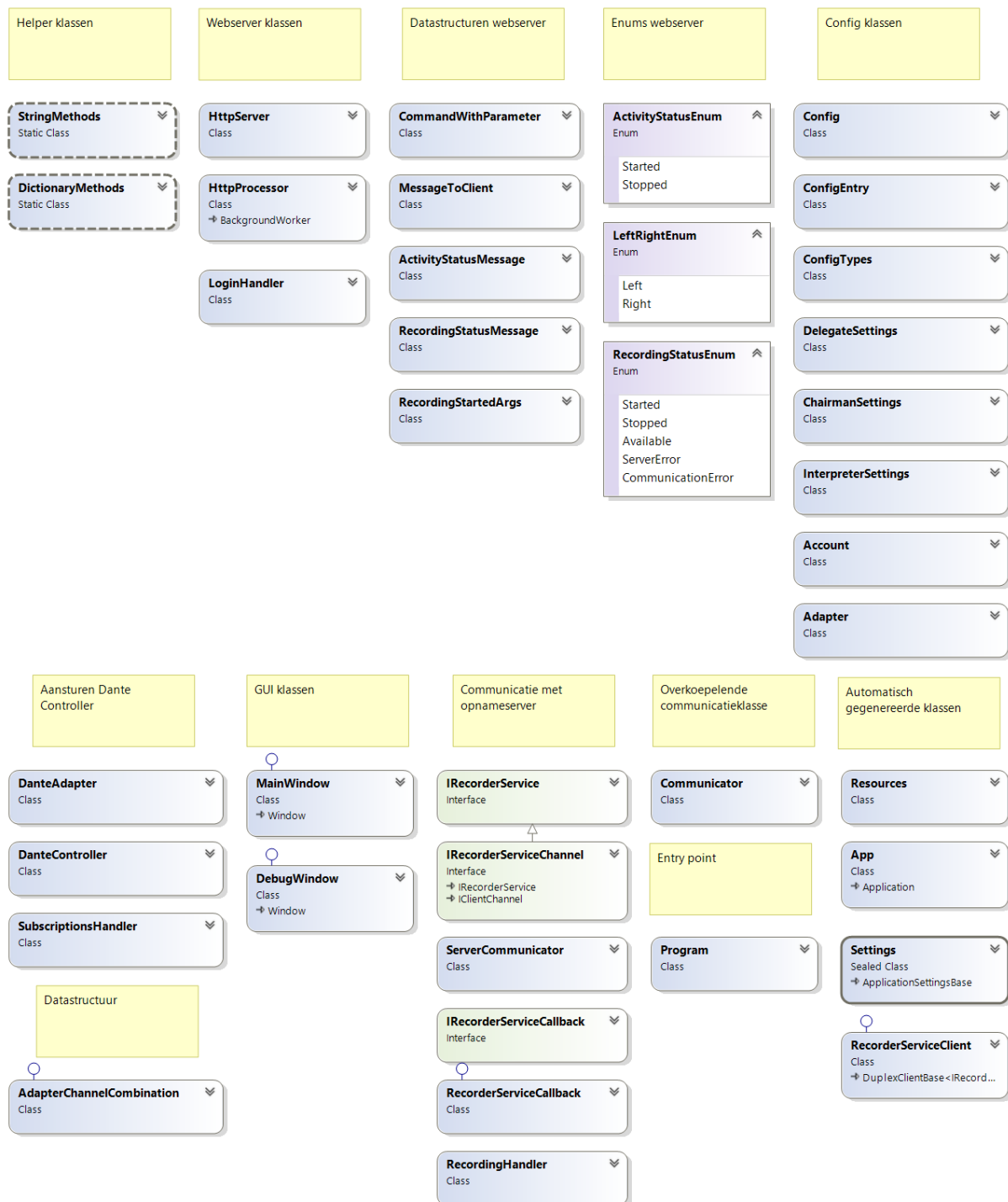
Figuur 9.1: Klassendiagram van virtual_iq_server
