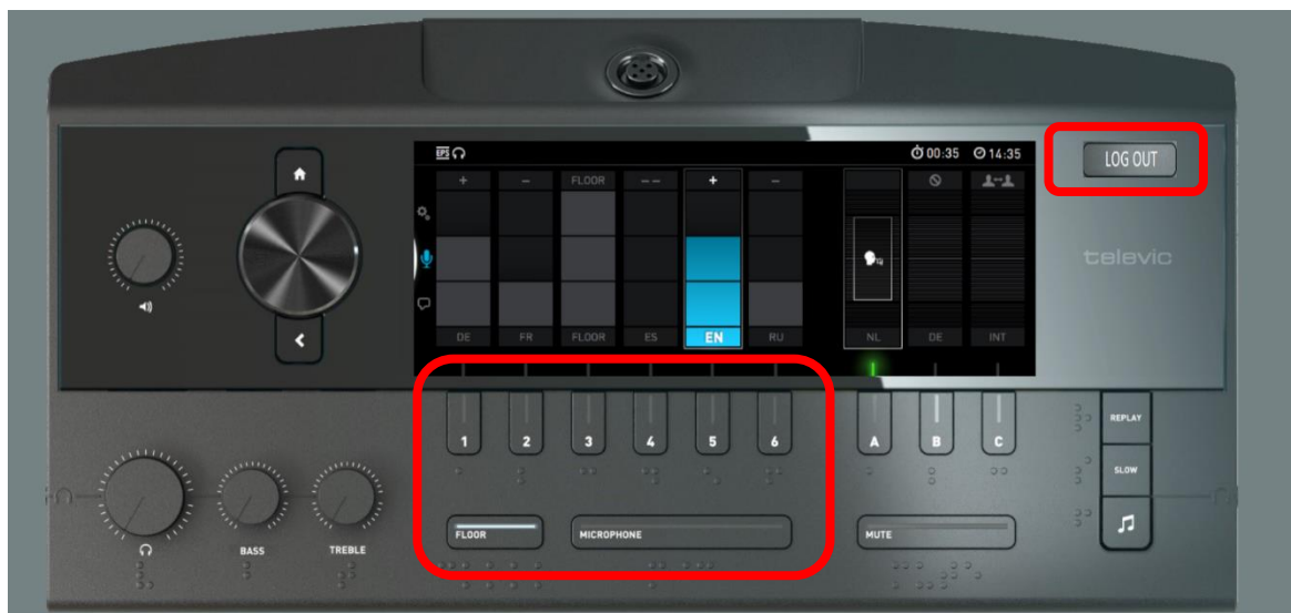
Figuur 3.1: Reeds bestaande GUI voor tolken (Met toegevoegde LOG OUT knop)
