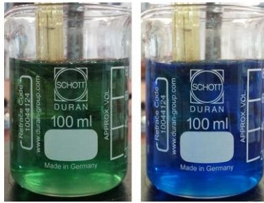
Figuur 11: Kleuromslag broomthymolblauw bij verschillende pH-waarden. Links pH 6.83 rechts 8.43
