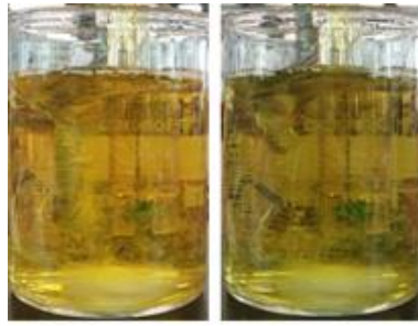
Figuur 13: Kleuromslag broomthymolblauw bij verschillende pH-waarden. Links pH 4.58 rechts 5.48
