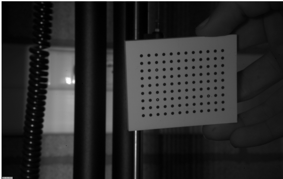
Figuur 5.4: Het kalibratieplaatje tijdens het kalibreren van de camera opstelling
