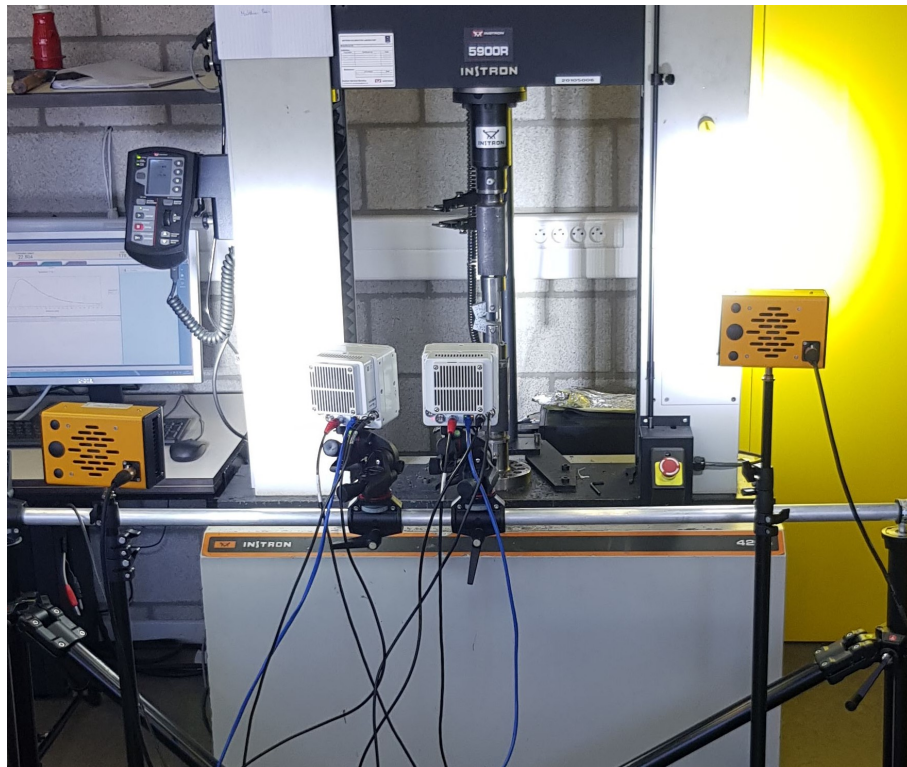
(a) High speed camera's en lampen opgesteld aan de trekbank
