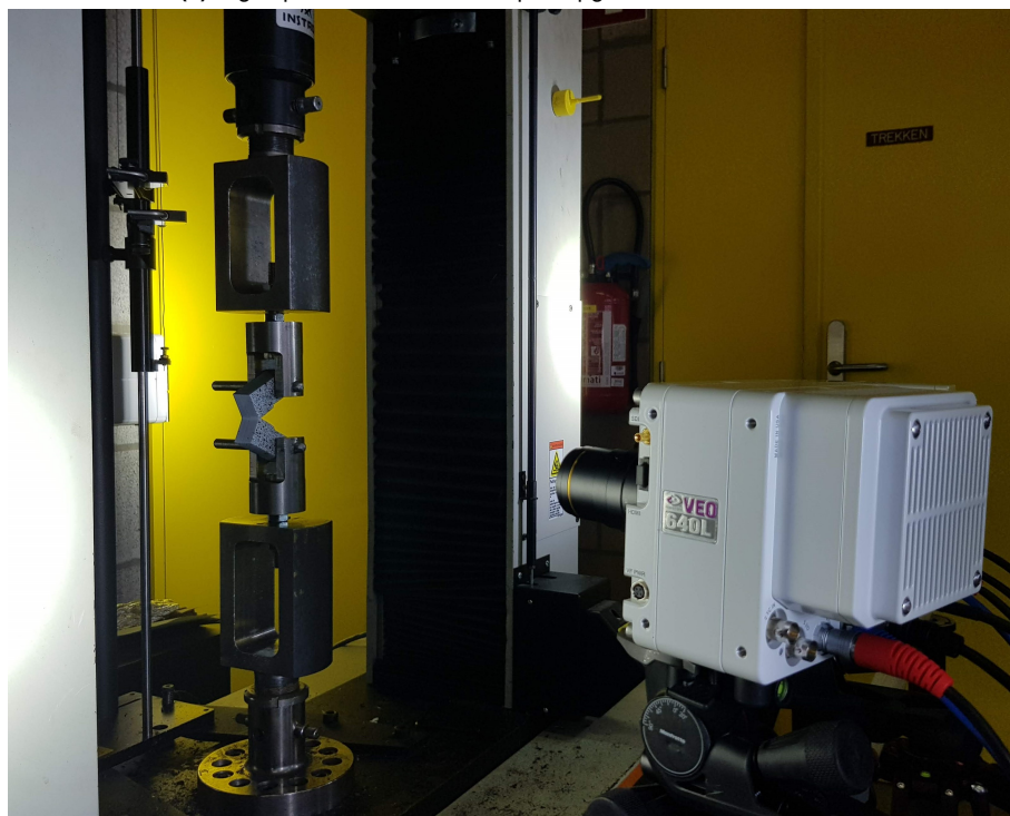
(b) Ingeklemd proefstuk en een high speed camera
