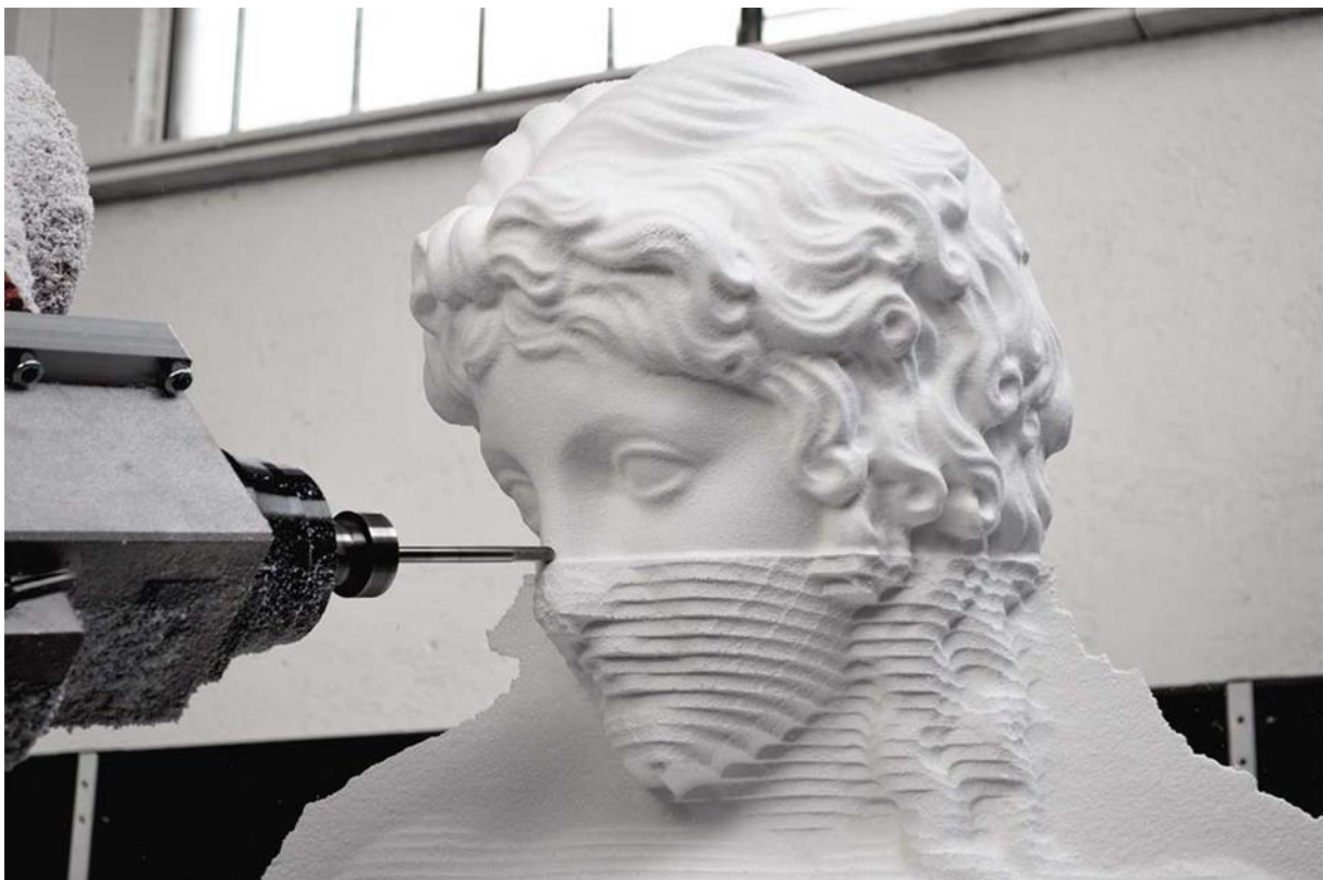
(Illustratie 28: Het freesproces met onderaan de sporen van het ruwfreen en bovenaan de tweede 'pas' waarbij de details worden uitgewerkt.)
