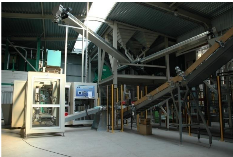
Figuur 3: Automatische opzaklijn (capaciteit 1000 zakken/ uur)
