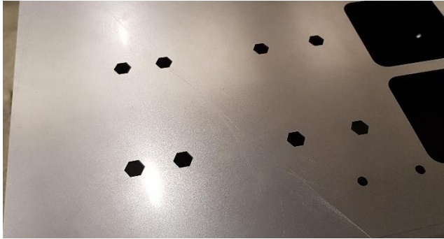
Figuur 65: Zeskantgaten en maken van afschuining
