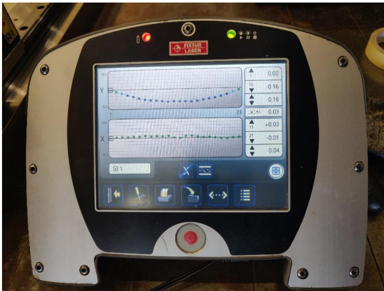
Figuur 95: Laatste meting referentie geleiding
