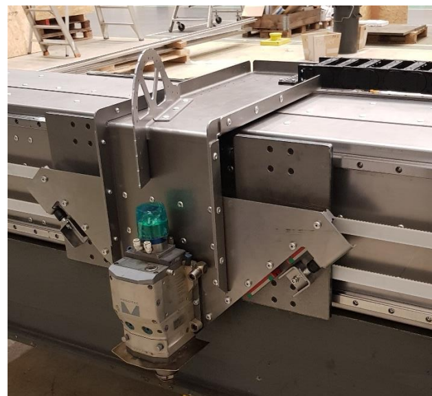
Figuur 73: Assembleren van de verbindingsplaat van de wagens en de kabelgeleider
