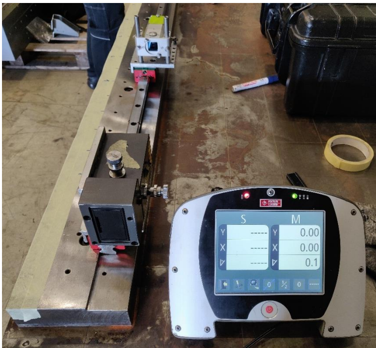
Figuur 93: Refereren laser
