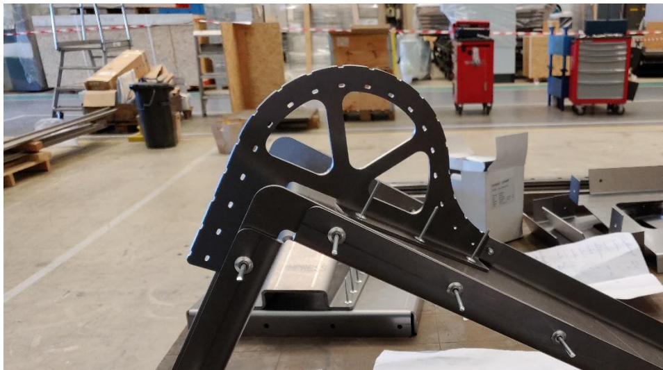
Figuur 19: Kabelgeleider met radius
