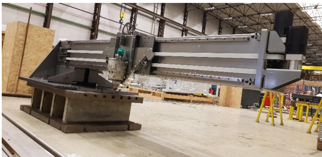
Figuur 77: Monteren van het portaal
