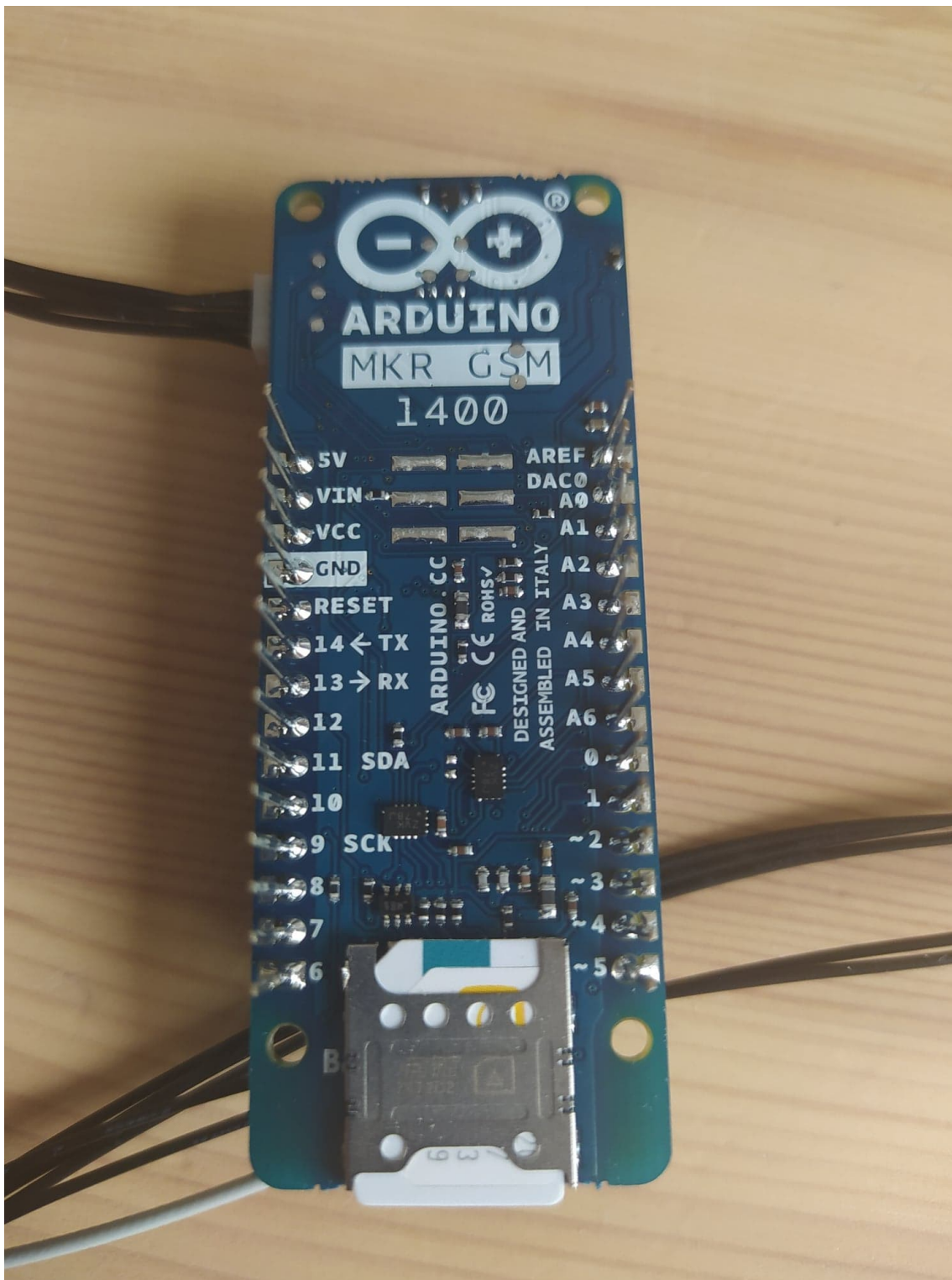
Figuur 5.2: Achterkant van de MKR 1400 gsm module waar de simkaart wordt geplaatst
