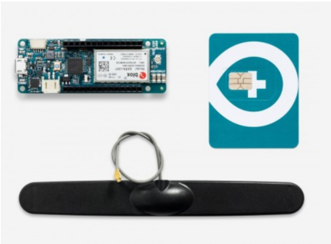
Figuur 3.1: Arduino MKR 1400 GSM module (Arduino, g.d.). Linksboven = Arduino MKR GSM, onderaan = GSM antenne, rechts = simkaart
