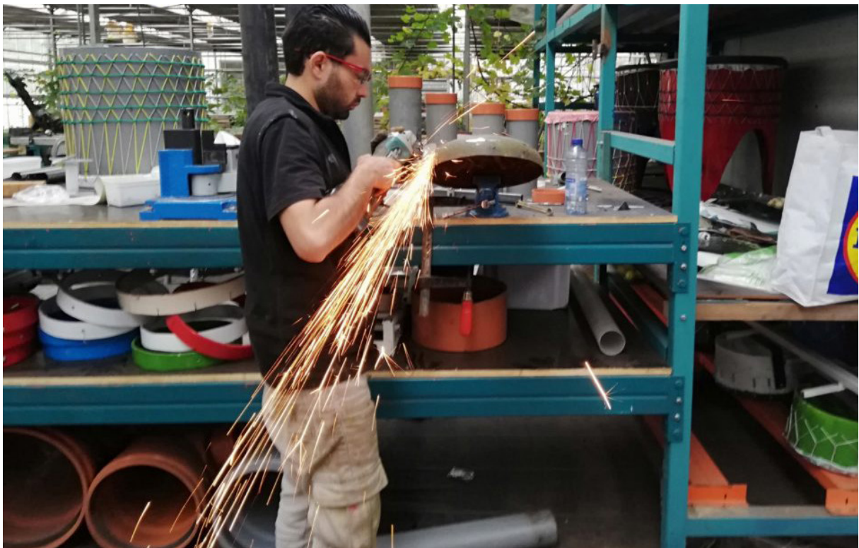
(afb. 81) Het maken van een gastong (vervaardigd van een gasfles)
