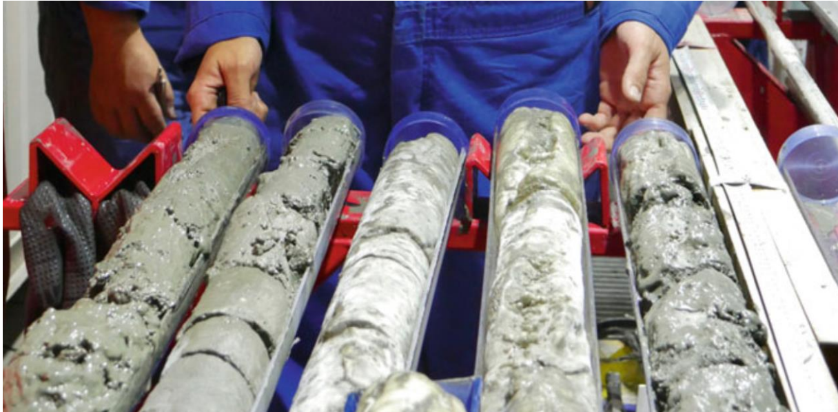
Figuur 20 Staalnames van gashydraten door boringen van Geotek Coring Ltd. Witte oppervlakken zijn geconcentreerde gashydraten
