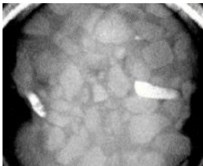
Figuur 19 CT scan van methaanhydraat
