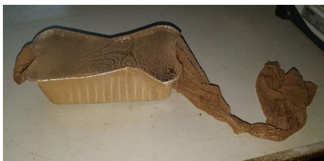
Figuur 6.1 Nylonkous om de massa zandvliegasmengsel te beschermen
