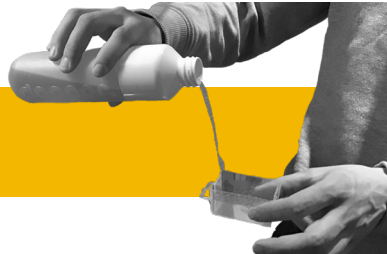
Lokaas (nutriënt agar) in de container van de collector gieten
