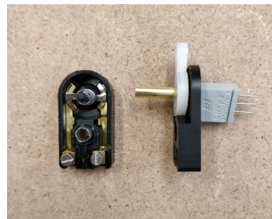
Gehackte trekschakelaar met ingewerkte trim potentiometer.
