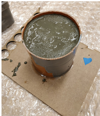
Test van het gieten van beton in een pvc mal en de uiteindelijke mal met doorgevoerde aanpassingen.
