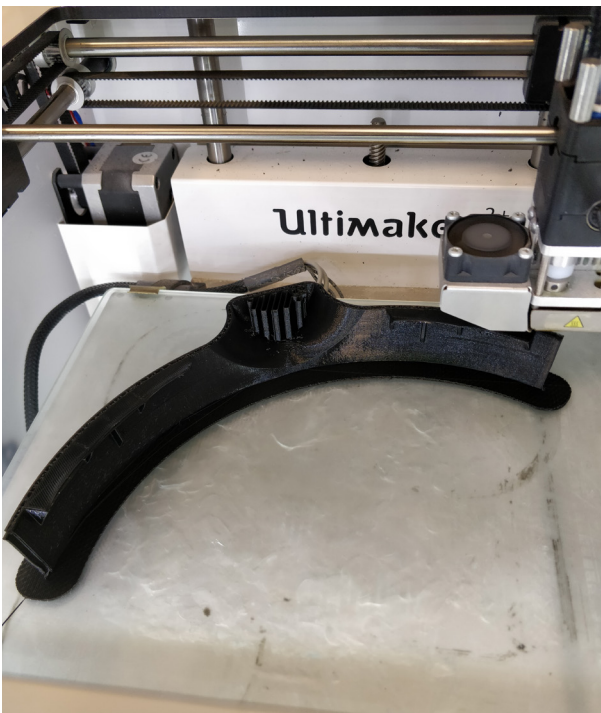
3D-printen van één van de drie delen waaruit de romp van Lumo gemaakt is.
