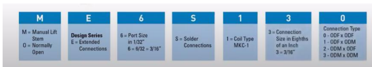
Figuur 79: De componentnaamgeving door fabrikant Sporlan
