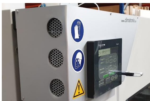
Figuur 139: De ventilatiegaten
