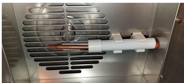
Figuur 132: De sensoren opgesteld in de aanzuig van de ventilator
