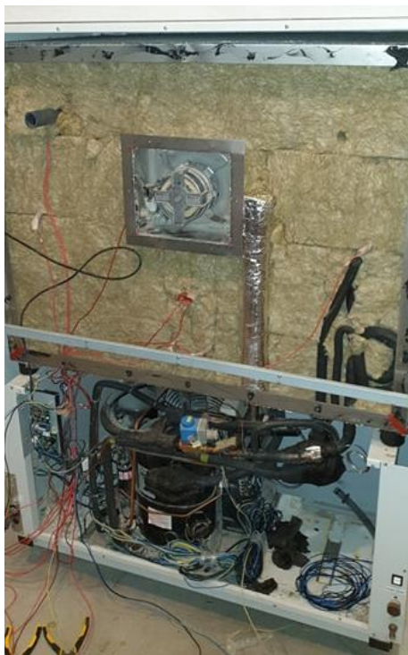
Figuur 124: De klimaatkast na demontage van de bevochtiger
