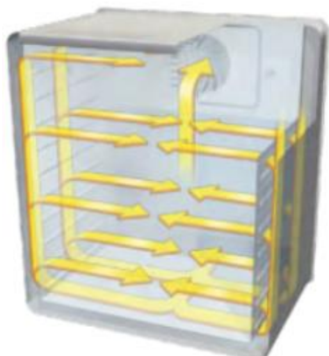
Figuur 28: De luchtverdeling via de luchtgeleidingswanden
