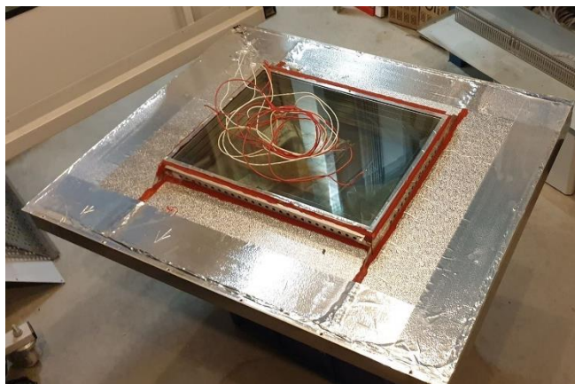
Figuur 15: De binnenkant van deur met de verwarmingsweerstand van de Binder mkf 240
