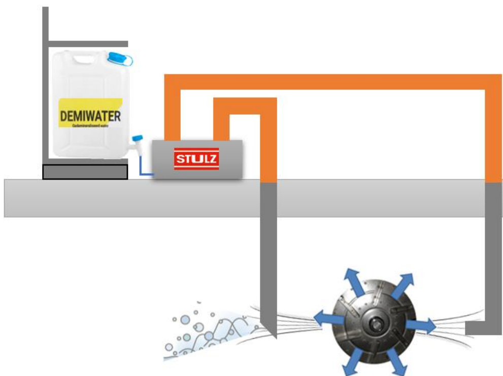
Figuur 93: De opstellingsmethode bij aanblazing met procesventilator bij de FN 400HAD
