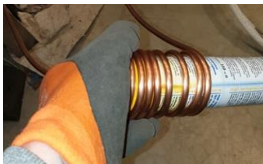
Figuur 127: Het plooiën van de vochtspiraal
