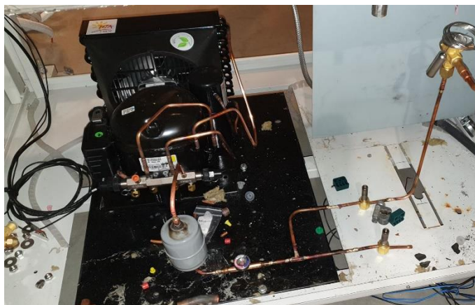
Figuur 128: Het opbouwen van het koelcircuit
