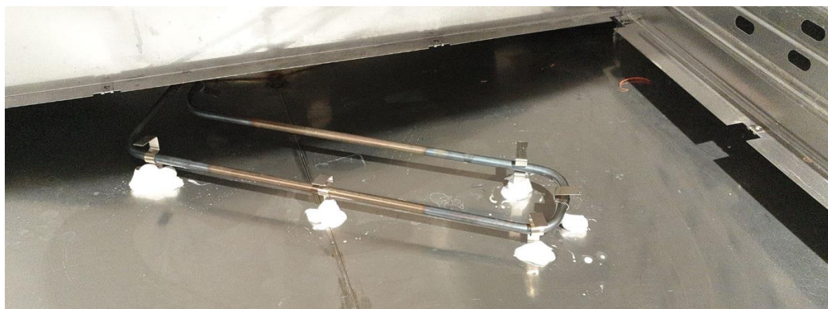
Figuur 131: De elektrische weerstand opgesteld in de beugels
