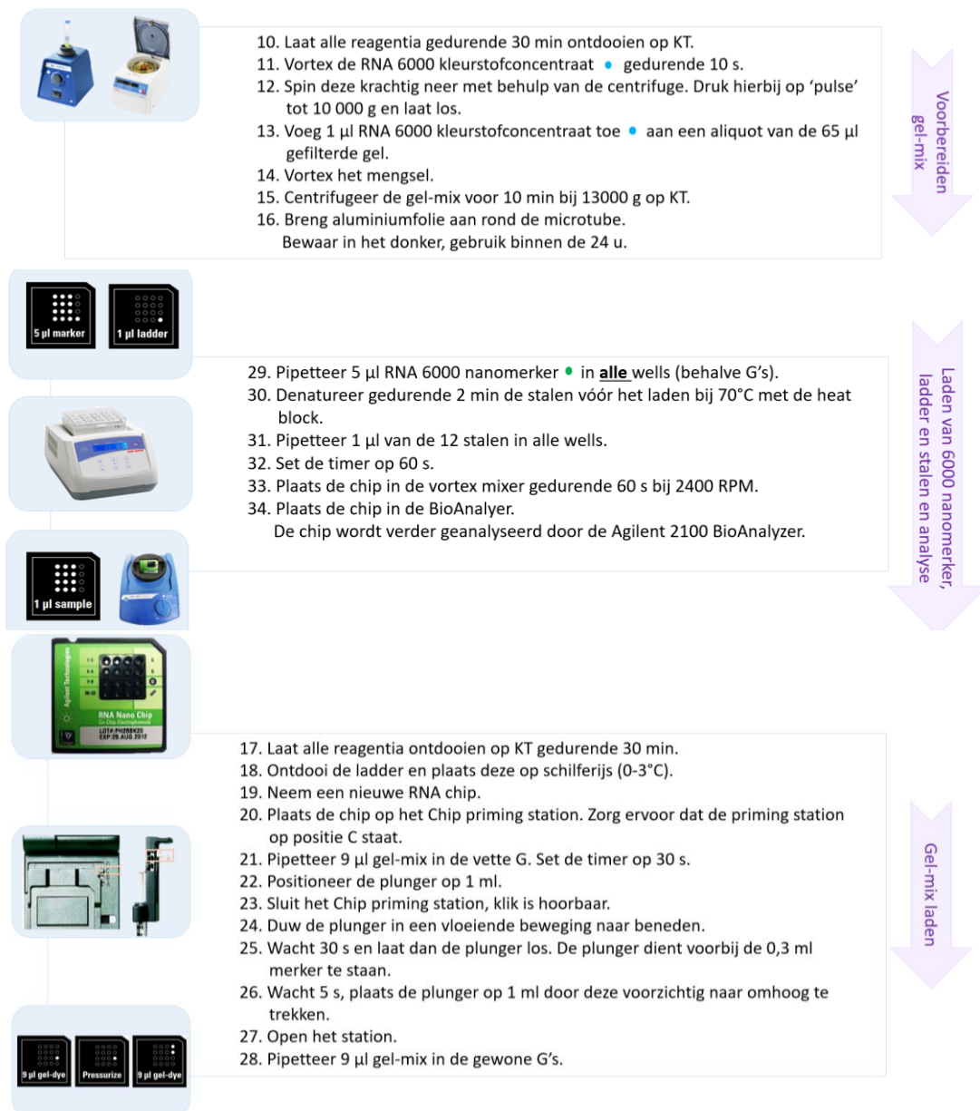
Figuur 13: Gedetailleerd protocol voor het bepalen van de RIN-score. KT= kamertemperatuur; RPM= revolutions per minutes, C= controle, G= gauge.
